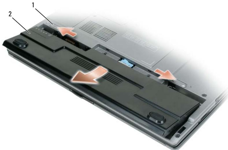
1 защелка отсека аккумулятора    2 основной аккумулятор
