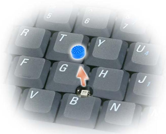
**1** Снимите колпачок с микроджойстика.
